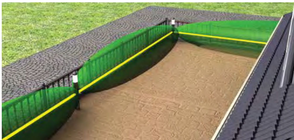
Protection du périmètre à l'aide de la barrière bistatique double technologie FORTEZA-FONAR-COMBI
