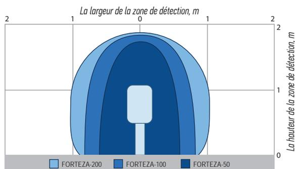
Relation entre la largeur/hauteur de la zone de détection et la modification des détecteurs
